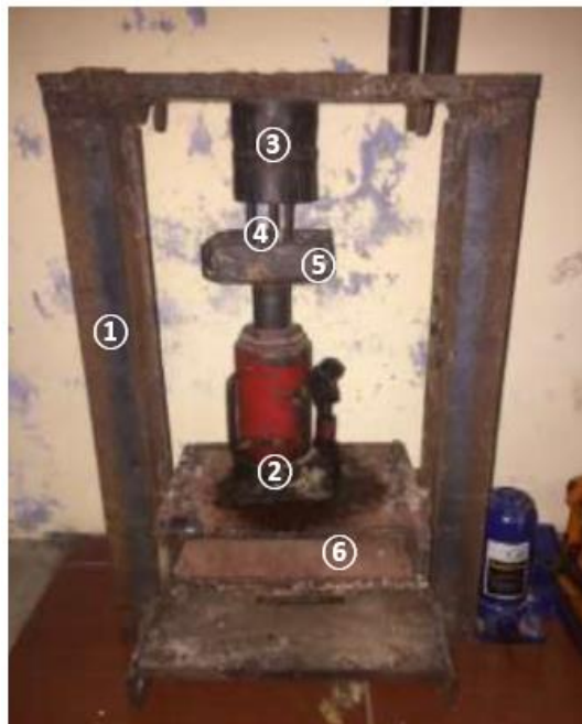
Gambar 2. Pencetakan pelet menggunakan dongkrak: 1) rangka, 2) dongkrak, 3) cetakan ( die ), 4) batang penekan, 5) bantalan batang penekan, 6) landasan
